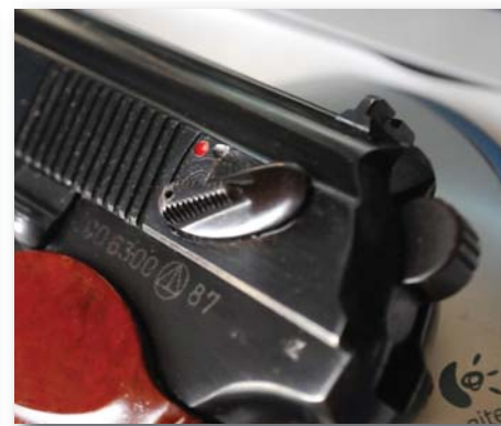
Команда кочнице на задњем делу левог бока навлаке: горе – закочено, доле – откочено
